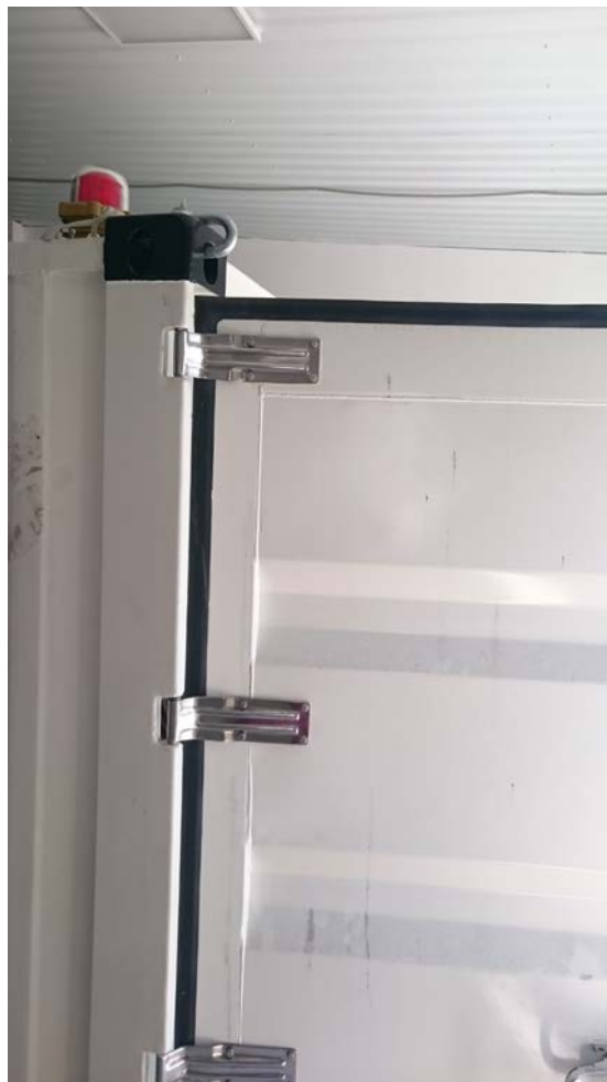
Сигнальная лампа при проведении высоковольтных испытаний
