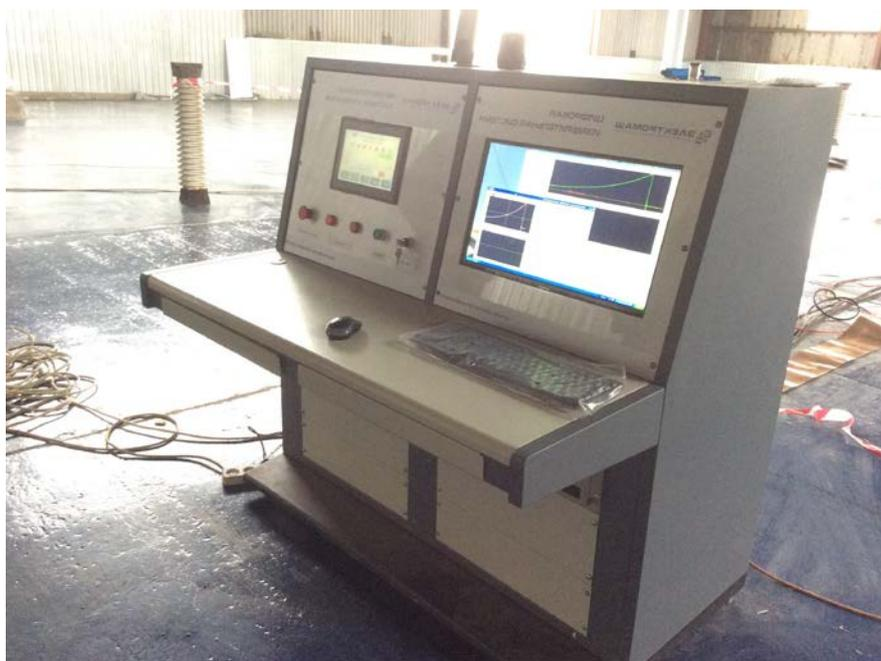
В соответствии со стандартом ГОСТ эта система служит для измерений и анализа импульсных сигналов грозовых и коммутационных импульсных напряжений в процессе высоковольтных испытаний (пиковое значение, длительность фронта, время до половинной амплитуды, время до срезания). Графическая программа ориентирована на управление через меню. Система рассчитана на применение в помещении. Раз-
