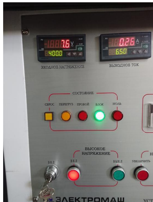
Пульт управления и измерения в низковольтном отсеке (автоматический, на базе промышленного компьютера с сенсорным экраном или вариант с ручным управлением)
