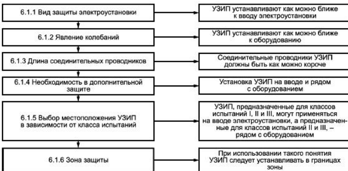
Рисунок 9 - Информационная схема применения УЗИП
