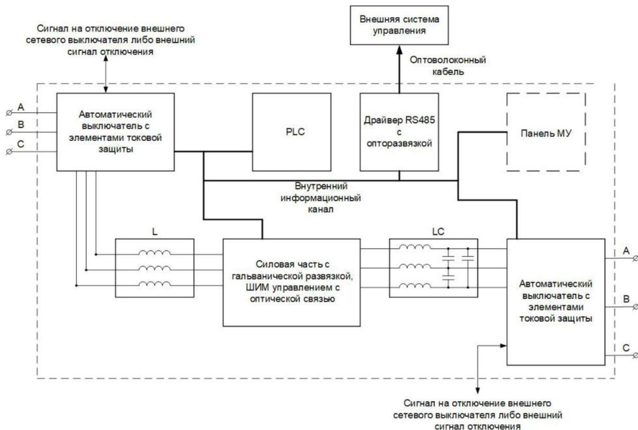
На входе и на выходе СПЧ установлен автоматический выключатель с элементами токовой защиты и автоматики. Имеется дискретный выход для обеспечения сигнализации о срабатывании токовой защиты во внешние цепи управления, а также дискретный вход для обеспечения быстрого отключения по сигналу внешних цепей.
