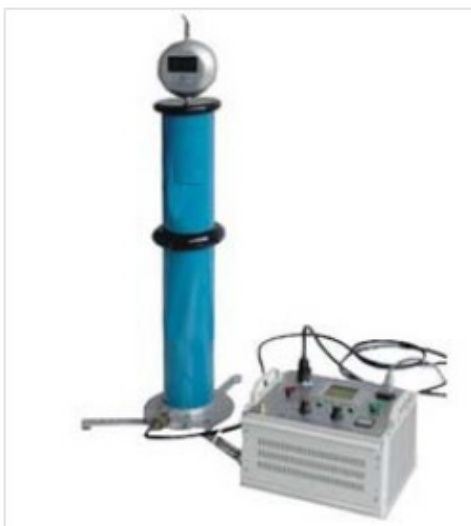
Высоковольтный блок испытания выпрямленным напряжением со встроенным контролем тока утечки, расчетом коэффициента нелинейности, защитой от перегрева обмоток. ИПТ-100
