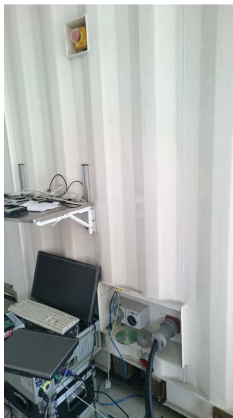
Разъемы для подключения питания, ноутбука для автоматического управления
