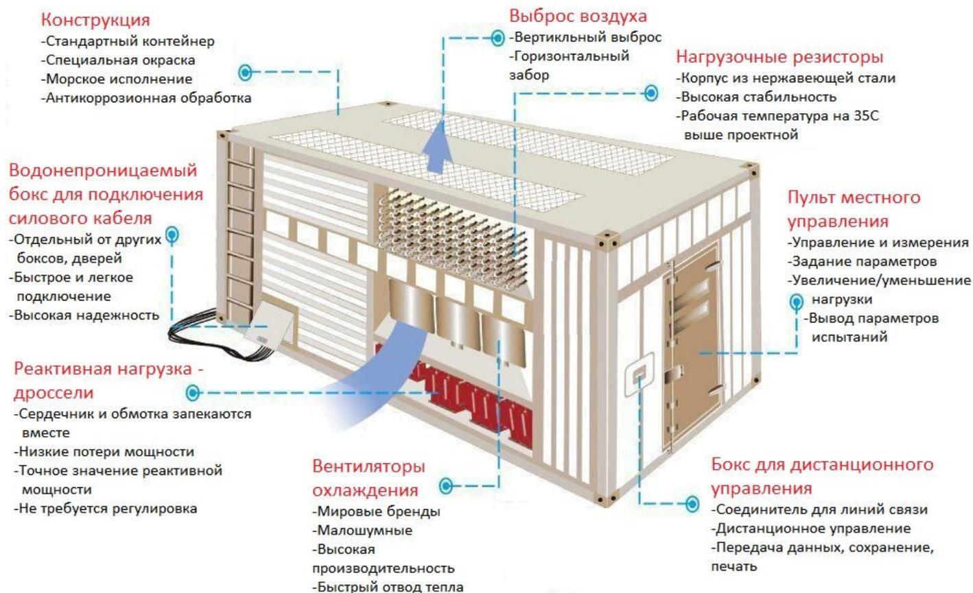
Общая схема расположения элементов НУ (Реакторы отсутствуют для данного проекта)
