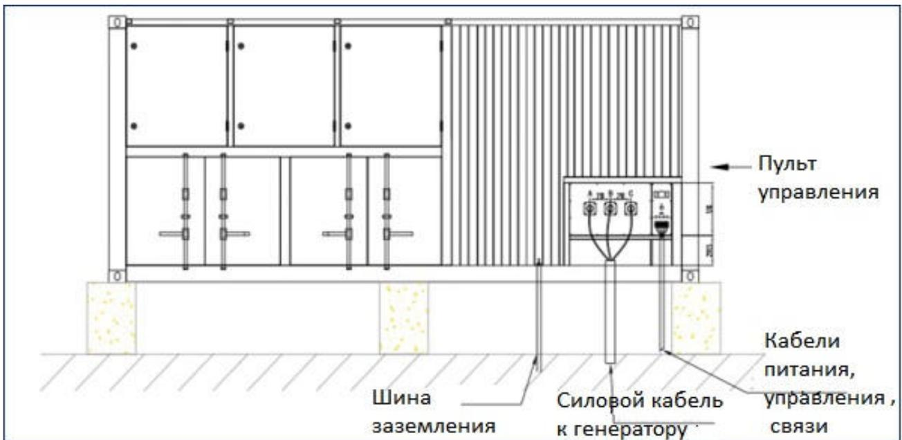
Схема монтажа и подключения
