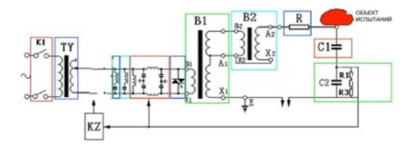
K1 K: распределительный шкаф ШРН ТУ: трансформатор изолирующий
