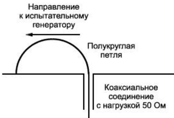
Рисунок D.3 - Полукруглая петля на пластине заземления
