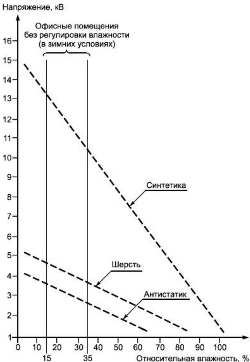
Рисунок А.1 - Максимальные значения напряжения, до которого могут быть заряжены операторы при контакте с материалами, приведенными в разделе А.2
