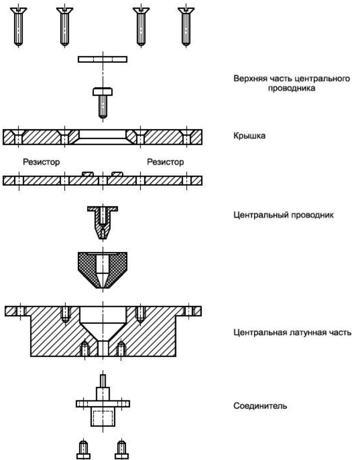
Рисунок С.5 - Чертеж коаксиального датчика (лист 5 из 5)
