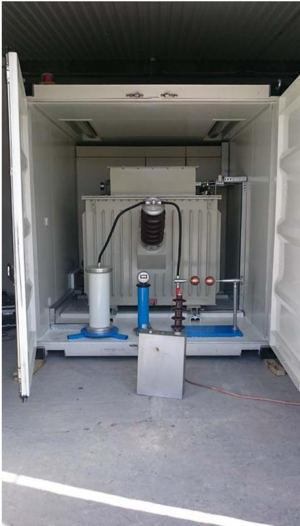
**Высоковольтный отсек с резонансным трансформатором, делителем напряжения, шаровым разрядником и блоком выпрямленного напряжения**
