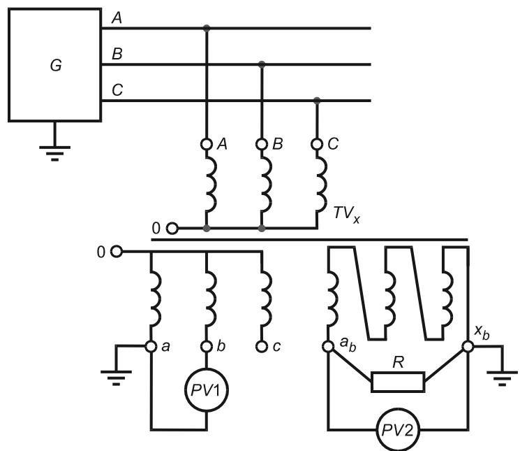
$TV_x$  — поверяемый трансформатор;  $G$  — источник трехфазной системы напряжений;  $PV1$  — вольтметр с пределом измерения 150 В;  $PV2$  — вольтметр с пределом измерения 5—7 В;  $R$  — нагрузочное устройство дополнительной обмотки
