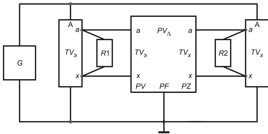
*G* — источник высокого напряжения; *TV<sub>э</sub>* — эталонный трансформатор; *R1* — нагрузочное устройство эталонного трансформатора; *TV<sub>x</sub>* — поверяемый трансформатор; *R2* — нагрузочное устройство поверяемого трансформатора; *PV<sub>Δ</sub>* — прибор сравнения; *PV* — функция измерения входного напряжения; *PF* — функция измерения частоты входного напряжения; *PZ* — функция измерения нелинейных искажений
